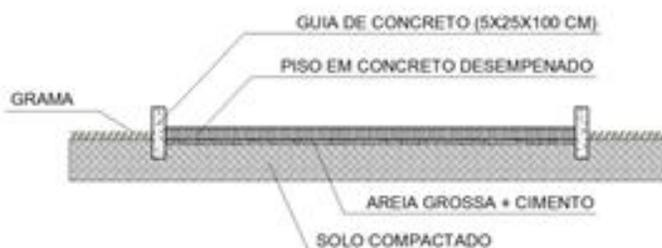
Corte esquemático da calçada.
