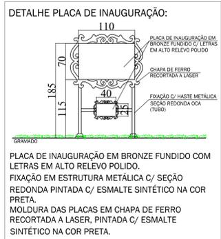
PLACA DE INAUGURAÇÃO EM BRONZE FUNDIDO COM LETRAS EM ALTO RELEVO POLIDO. FIXAÇÃO EM ESTRUTURA METÁLICA C/ SEÇÃO REDONDA PINTADA C/ ESMALTE SINTÉTICO NA COR PRETA. MOLDURA DAS PLACAS EM CHAPA DE FERRO RECORVADA A LASER, PINTADA C/ ESMALTE SINTÉTICO NA COR PRETA.
